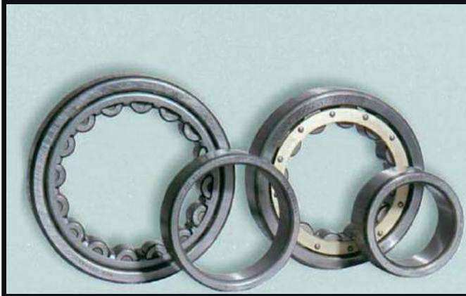
NU Tipinin dış bileziğinin iki faturası olup, iç bilezik faturasızdır.
