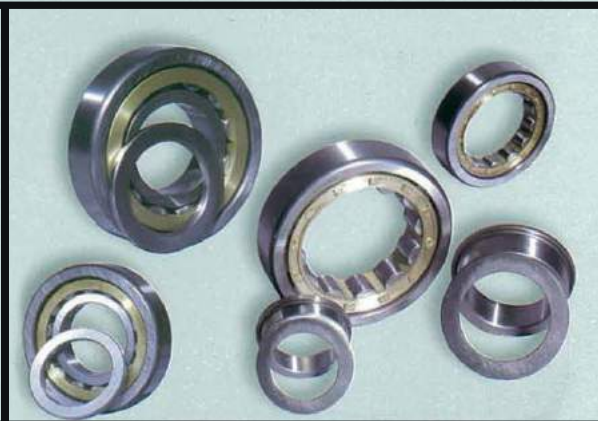
NUP tipindeki silindirik makaralı rulmanların dış bileziğinde iki fatura olup, iç bileziğinde sabit bir fatura ve serbest bir fatura kapağı bulunur. Değişken yöndeki aksel kuvvetleri karşılar.
