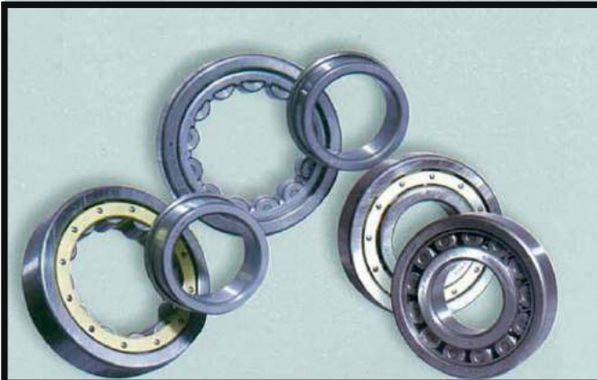
NJ Tipindeki silindirik makaralı rulmanların dış bileziğinde iki fatura bulunur. Buna karşılık iç bilezikte tek fatura vardır. Böylece tek yöndeki aksel kuvvetleri karşılayabilirler.
